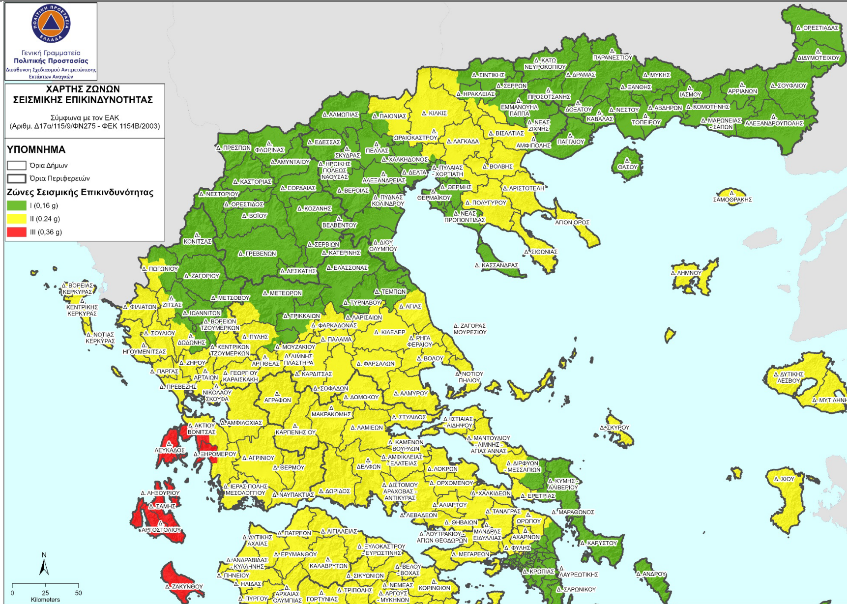
Εικόνα Γ.2. Χάρτης Σεισμικής Επικινδυνότητας του βόρειου τμήματος της χώρας σε σχέση με τα όρια των Δήμων.
