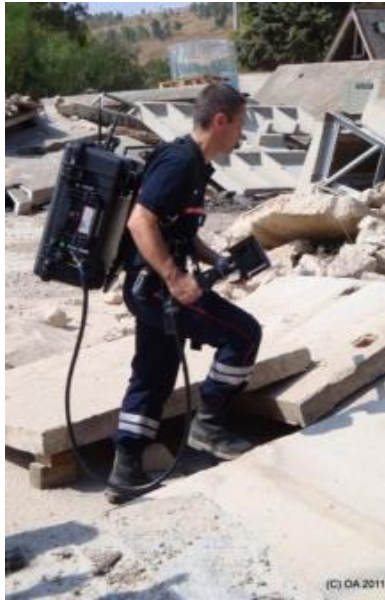
Εικόνα 3. Συσκευή για τον εντοπισμό παγιδευμένων ατόμων στα ερείπια, η οποία παρέχει χημικά “ΣΗΜΑΔΙΑ ΖΩΗΣ” μαζί με ακουστικά και οπτικά δεδομένα (Συσκευή FIRST) [30]
