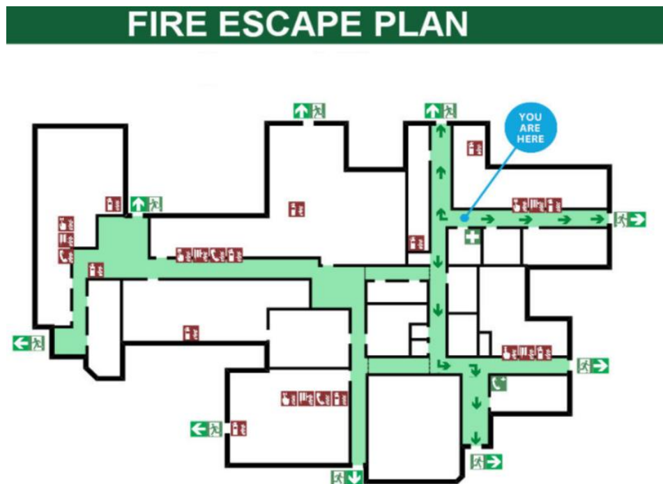
Εικόνα 5. Ενδεικτικό παράδειγμα “Σχεδίου Διαφυγής και Διάσωσης”, σύμφωνα με το πρότυπο ISO 23601:2009 [39]
