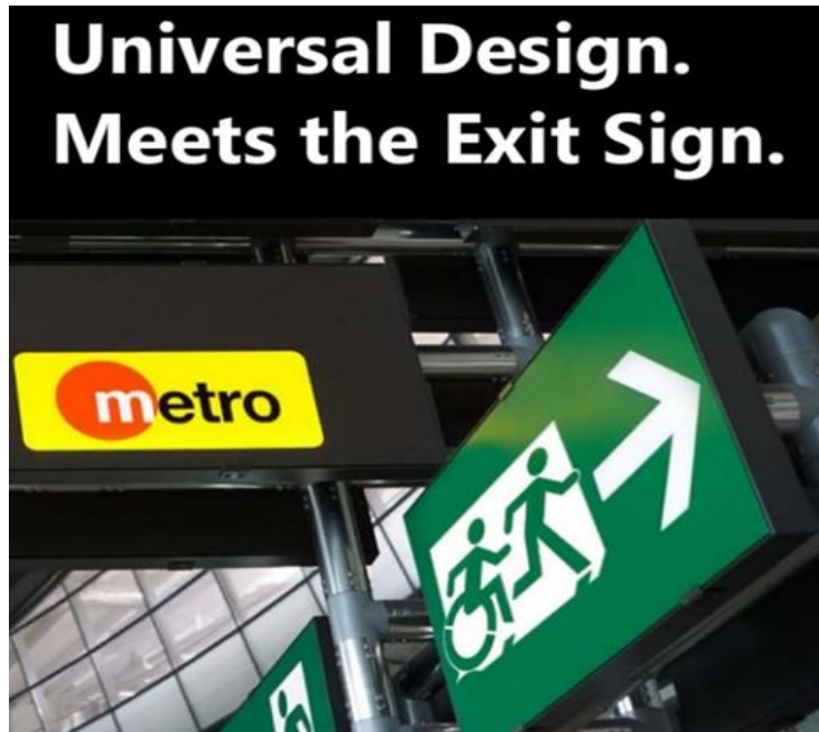
Εικόνα 18. Το πρόγραμμα “Accessible Exit Sign Project” (Προσβάσιμη Έξοδος) εισάγει τη νέα γενιά σημάτων διαφυγής, που είναι ειδικά σχεδιασμένα για άτομα με αναπηρία [54, 55]
