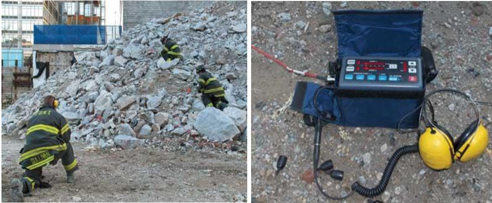
Εικόνα 2. Πολλές ομάδες διάσωσης χρησιμοποιούν ενισχυτές ήχου, προκειμένου να ανιχνευθεί πιθανώς η φωνή του θύματος κάτω από τα ερείπια Tom Donnelly, Fire Engineering (2010) [29]
